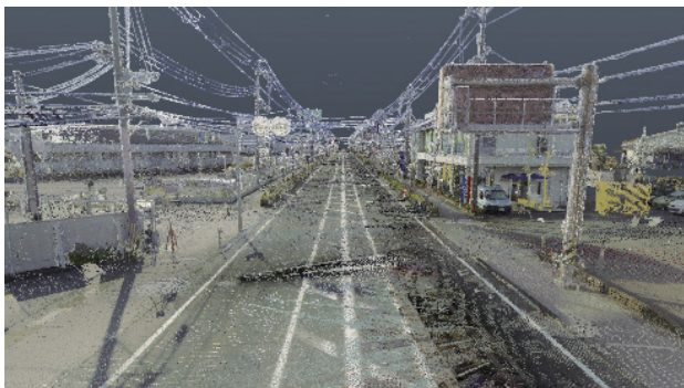
図-1 3Dレーザ測量による3次元点群データ
