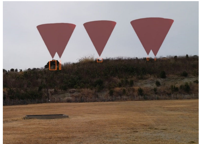
制限表面を超えた樹木を検知した際の HoloLens 2 の映像(注 12)
