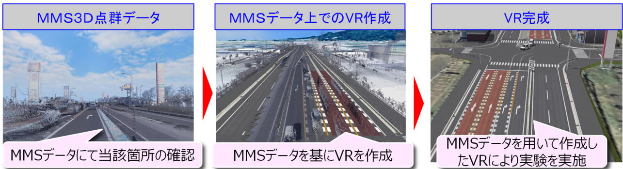
図1 MMS3D 点群データを活用した VR の作成
