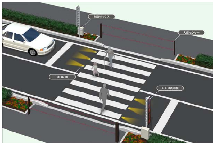
図1 「横断者感知式注意喚起システム」の構成
