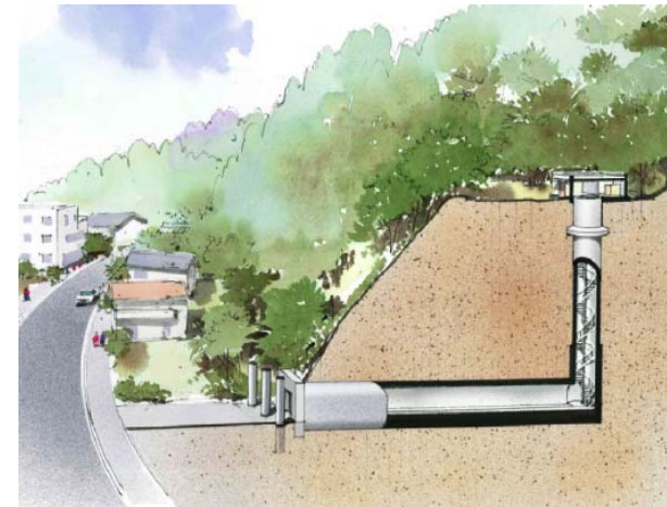
津波避難シェルター
