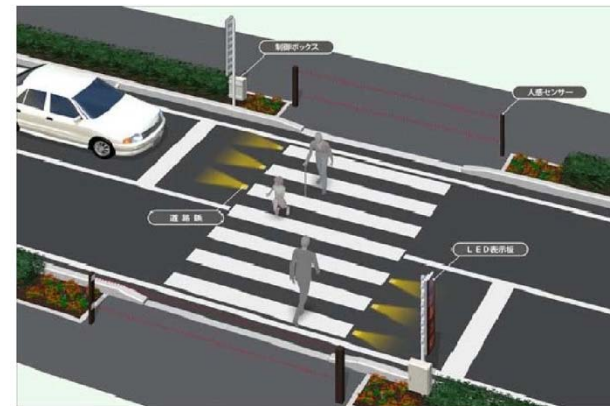
「横断者感知式注意喚起システム」の構成
