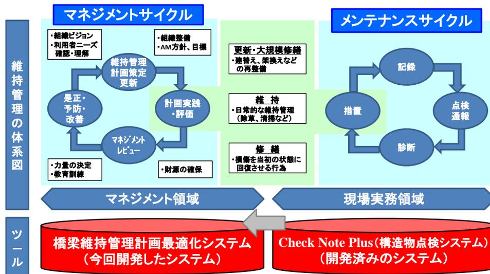
本システムは、以下の機能を有し、橋梁の長寿命化計画の見直しを容易に行えることが特徴です。
