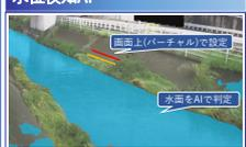
バーチャルで設定した水位線に、河川水位が迫るとアラートメールを発信するAIシステムです。現地の地物への着色が不要なため、カメラの設置のみで利用可能です。
