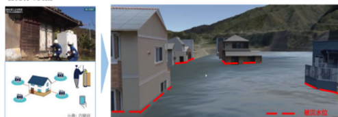
従前:罹災証明書発行の ための人力による調査 → ワンコイン浸水センサで取得した浸水履歴から被災水位を表示 (3D都市モデル+ワンコイン浸水センサ)
