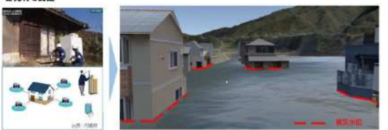
従前:復旧・復興期発生のための人による調査 → ワンコイン浸水センサで取得した浸水履歴から被災水位を表示 (3D都市モデル+ワンコイン浸水センサ)
