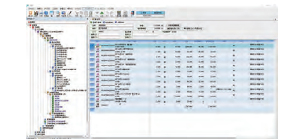
従来のCADシステム「瞭水」では、工事図面や工事数量計算書が簡単に作成できる。また、積算システム「明積」と連携させることで、図面作成から積算までの時間短縮も可能。
