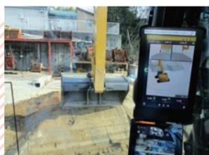
ICT建機が3次元モデルと同じ形状に施工
