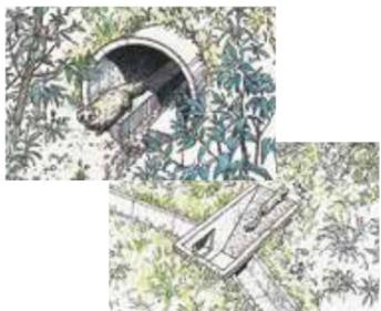
左上)パイプカルバートに小段を設け、タヌキなど哺乳類の横断経路を確保。右下)斜路付き柵を設置し、イタチやテンなど側溝に転落した小動物の這い出しに配慮。
