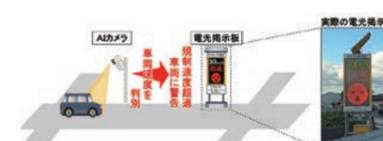
AIカメラとLED電光掲示板を連動させた注意喚起システムの概要
